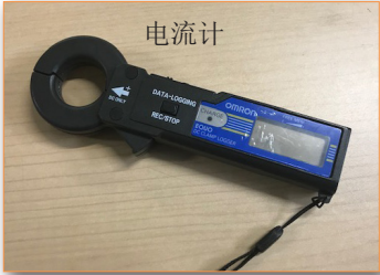
将电流计安装在电池旁
