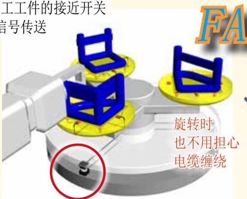
给焊装线上的托盘就位确认用接近开关
