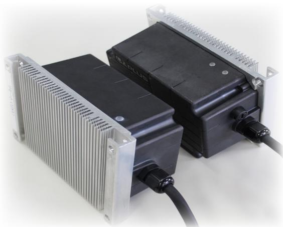
24V 납 축전지를 무선으로 충전합니다. 배터리의 잔압을 확인하고 CCCV 충전에서 충전합니다. 또한 완전히 충전 한 후 부동 충전 모드로 전환합니다. 배터리에 부하없이 안정된 전력으로 충전합니다.
