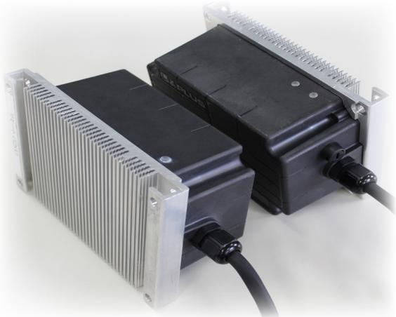
12V 납 축전지에 특화 한 대용량 충전 타입입니다. 8.5A의 대전류 12V 납 축전지를 무선으로 충전합니다. 또한, 배터리의 잔압을 확인하고 CCCV 충전에서 충전합니다. 또한 완전히 충전 한 후 부동 충전 모드로 전환합니다.
