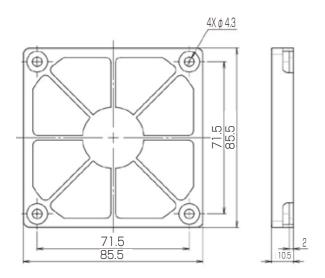
RCS2000AC(電源ユニット) の吸気口に取り付けてある ガード、専用フィルター、カバーのセットです。
