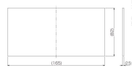
RCS2000AC(電源ユニット)の吸気口に取り付ける 専用フィルターです。フィルター交換の際にお使いください。
