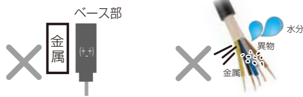
(図3) ベース部の金属対向 (図4) センサ内部に異物侵入
